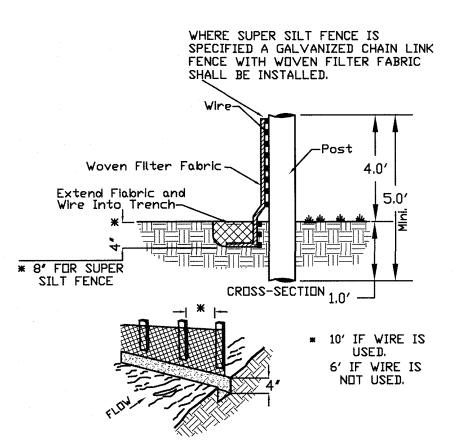
SF) CONSTRUCTION OF A SILT FENCE
