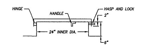
**ROOF MANHOLE** NO SCALE
