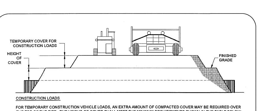
THE TOP OF THE PIPE. THE HEIGHT-OF-COVER SHALL MEET THE MINIMUM REQUIREMENTS SHOWN IN THE TABLE BELOW. THE USE OF HEAVY CONSTRUCTION EQUIPMENT NECESSITATES GREATER PROTECTION FOR THE PIPE THAN FINISHED GRADE COVER MINIMUMS FOR NORMAL HIGHWAY TRAFFIC.
