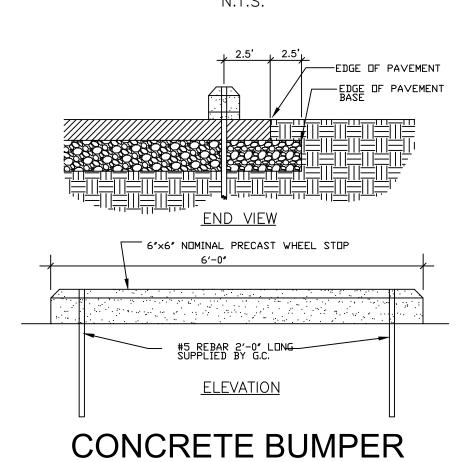
CONCRETE BUMPER BLOCK DETAIL
