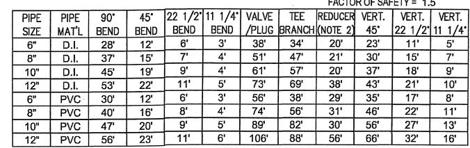
1. ALL JOINTS SHALL BE RESTRAINED ON BOTH SIDES OF THE FITTING FOR THE LENGTH SHOWN UNLESS OTHERWISE INDICATED. 2. REDUCER IS ONE SIZE SMALLER THAN PIPE LISTED. RESTRAINED LENGTH IS UPSTREAM ON THE LARGE SIDE OF THE REDUCER.
