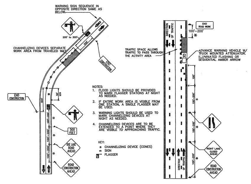
TRAFFIC CONTROL PLAN TYPICAL APPLICATION - LANE CLOSURE OPERATION ON TWO LANE ROADWAY
