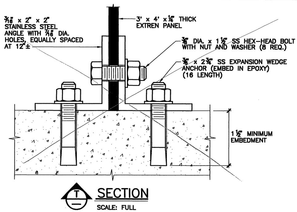
9 FIBERGLASS PUMP INTAKE BAFFLE (5 REQ.)
