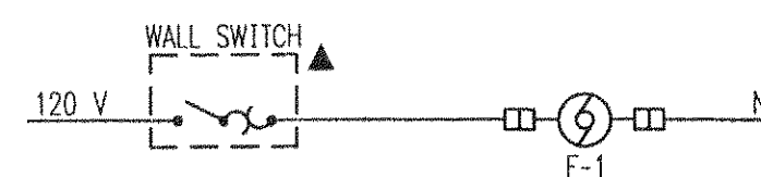
CEILING EXHAUST FAN
