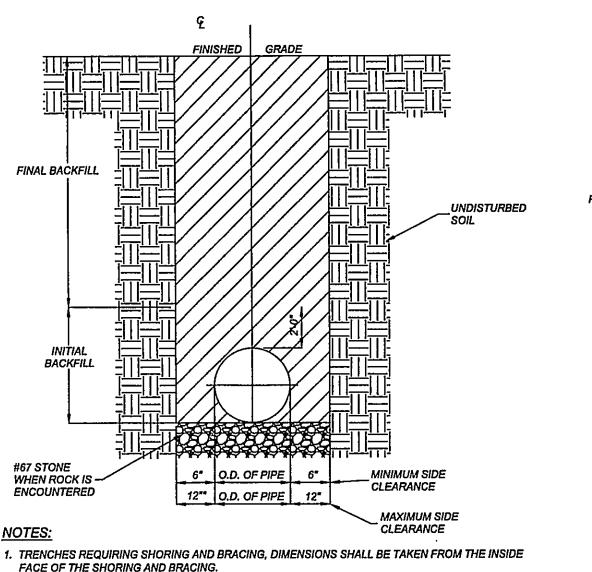
2. NO ROCKS OR BOULDERS 4" OR LARGER TO BE USED IN INITIAL BACKFILL. 3. ALL BACKFILL MATERIAL SHALL BE SUITABLE NATIVE MATERIAL.
