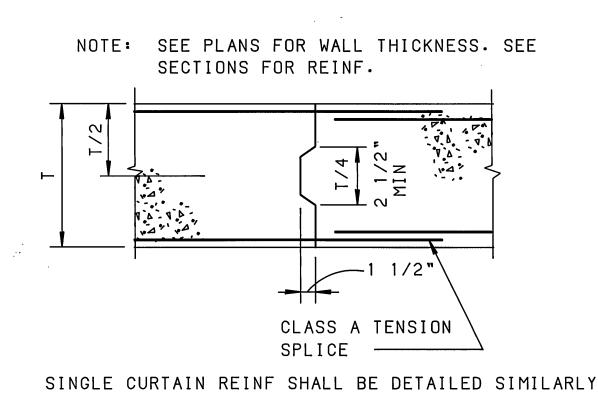
TYPICAL WALL CONSTRUCTION JOINT
