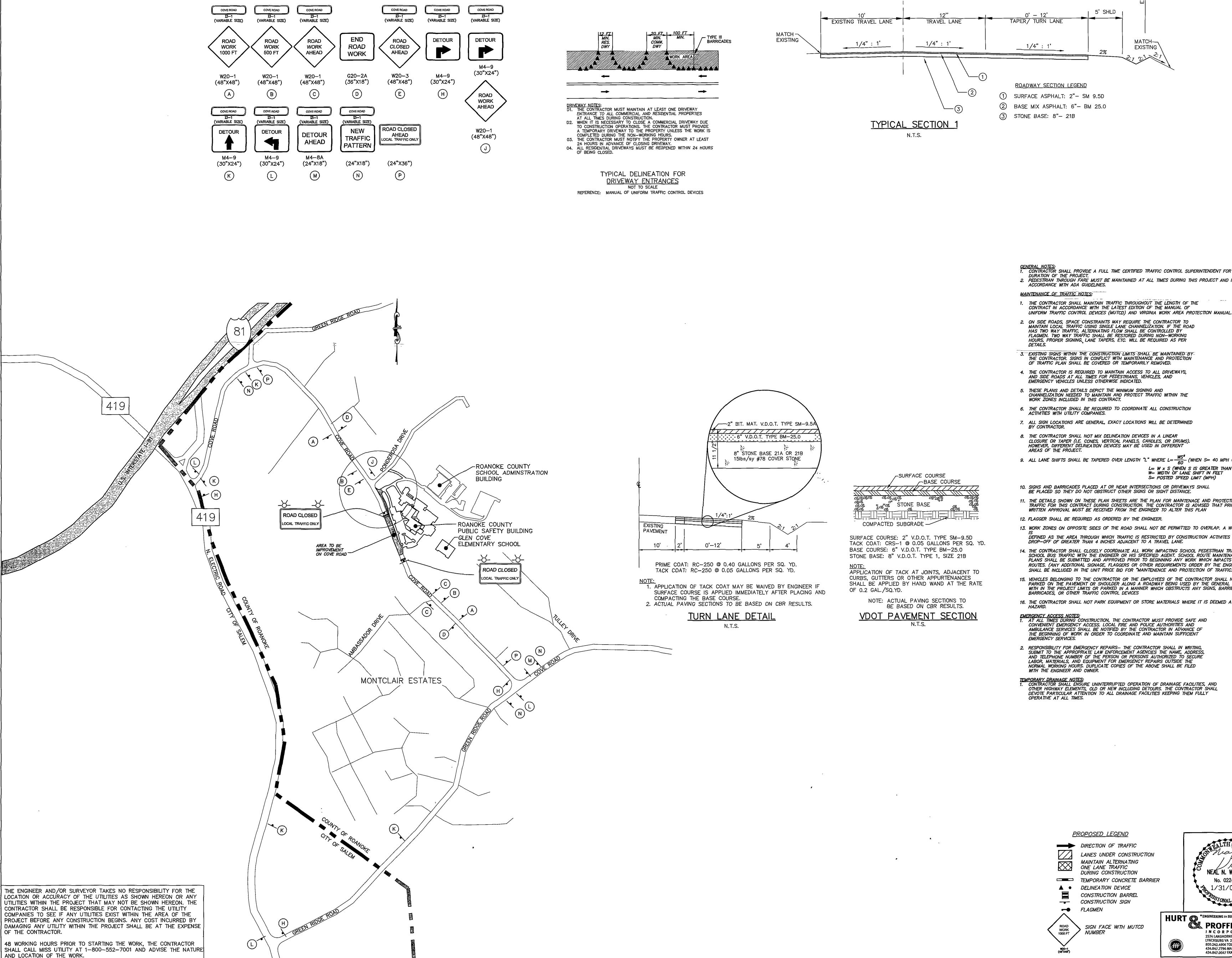
EXISTING ROADWAY SECTION LEGEND (1) SURFACE ASPHALT: 2"- SM 9.5D (2) BASE MIX ASPHALT: 6"- BM 25.0
